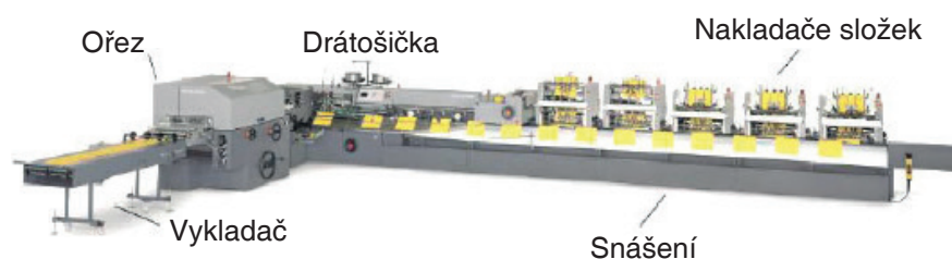
Obr. Linka s horizontálním snášením archů, šitím z drátu, falcováním a čelným ořezem.
