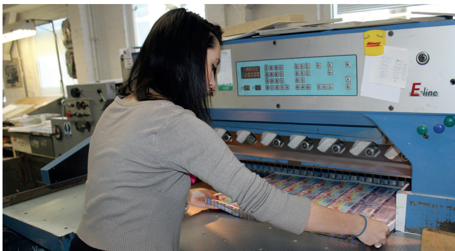
Obr. Postup řezání na průmyslové stohové řezačce
