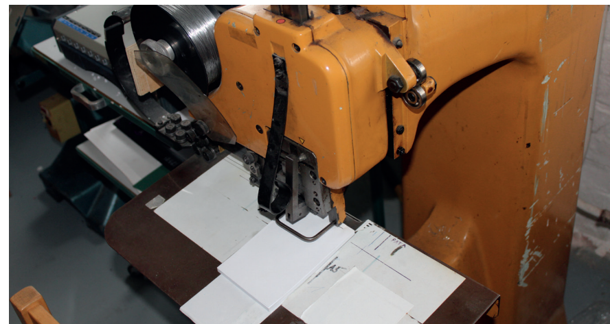
Obr. Šití vazby V3 na stojanové šičce.
