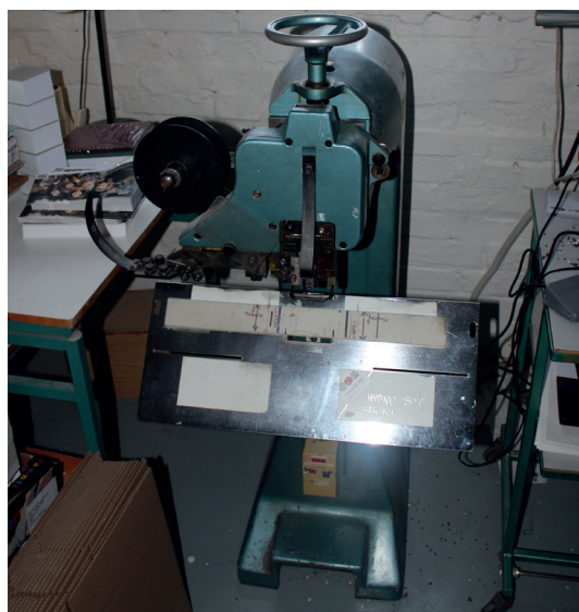
Obr. Stojanová šička z drátu – šití na stříšku.
