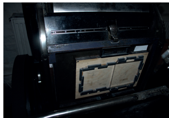
Obr. Knihtiskový stroj GrafoPress použitý pro výsek – má savkový vykladač i nakladač pro tiskové archy.
